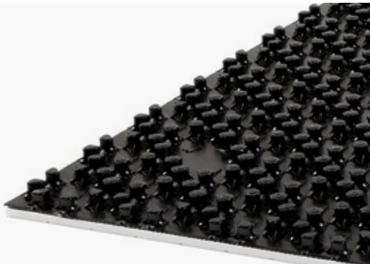
Die Variotherm Noppenplatten sind Rohrträger, Trennlage und Wärmedämmung (VarioNop) zugleich. Sie werden einfach per Druckknopfsystem verbunden. Als VarioFix ist sie auch ohne Wärmedämmung erhältlich.
